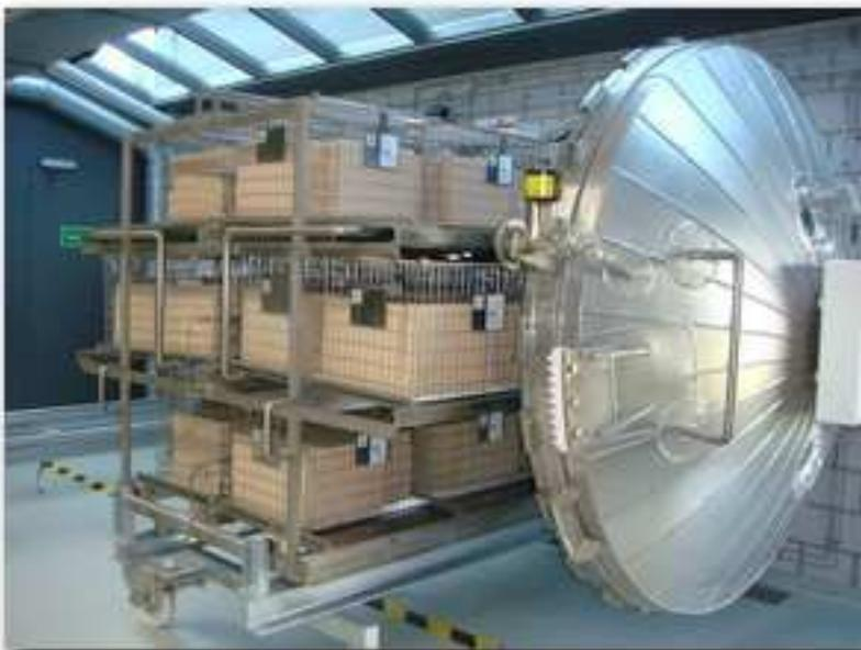
Les paniers sont sortis de la chambre de traitement après la désacidification et transférés aux chambres de reconditionnement automatiques. Pendant la phase de reconditionnement suivante qui dure environ 3 à 4 semaines, un certain volume d'air, à une température et un taux d'humidité définis, est soufflé à travers le matériel traité. Au cours de ce processus, le papier reprend l'humidité naturelle qui a auparavant été dégagée. Ensuite, le matériel désacidifié est retourné au client.
